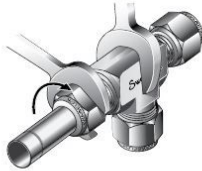
Abb. 2: Klemmringverschraubung Swagelok - Bei Montage : Gegenhalten.
